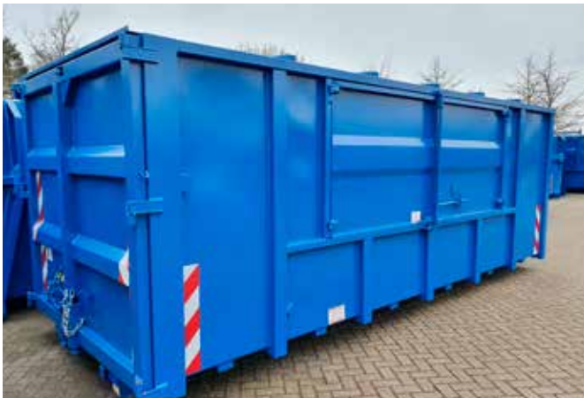
MZ container met aan de zijkant een luik. Het glas kan gemakkelijk hierdoor naar binnen worden gegooid. Als de container tot aan de onderrand van het luik is gevuld is ook het maximale gewicht al bereikt (10-12 ton).
